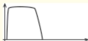
Talspänningen filtreras 300 Hz – 3400 Hz
